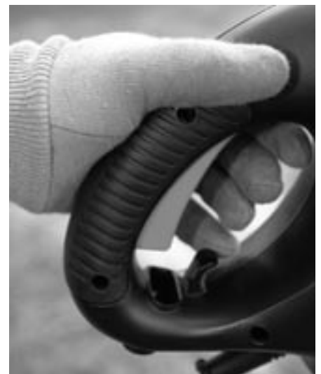
Figura 3-8: Suelte el interruptor del gatillo para parar la podadora
